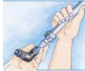
Montage von PE-Rohr mit Rohrverschraubungen: 1. Schieben Sie die Überwurfmutter und den Ring über das Rohr.
